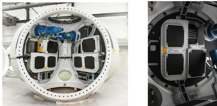
**Figure 8 – Moyeu d'une éolienne Nordex Version Gamma : Détail**
